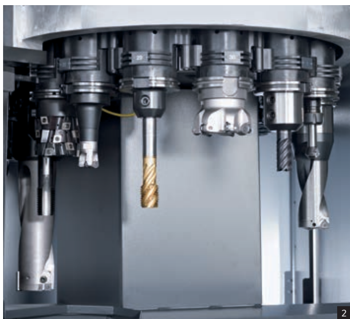
1: Интегрированный поворотный стол с ЧПУ 2: Инструментальный магазин на 30 инструментов в стандартном исполнении, опционально – на 60 или 120 инструментов 3: Токарно-фрезерная обработка с частотой вращения до 1 000 об/мин 4: Интегрированный стол для фрезерной и токарной обработки 5: Удобное оснащение инструментального магазина: автономные загрузочные дверцы и опциональные вспомогательные средства для переоснащения 6: 5-осевая обработка длинных составляющих с технологическими рамками и осью В
